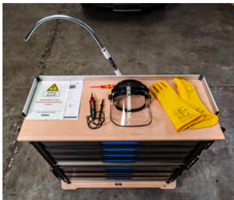
Poste de travail mobile pour interventions haute tension.
