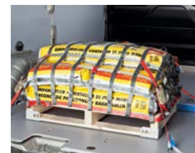
Arrimage du chargement combinant un filet et des traverses
